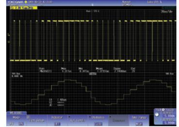
Trend display of waveform parameters
